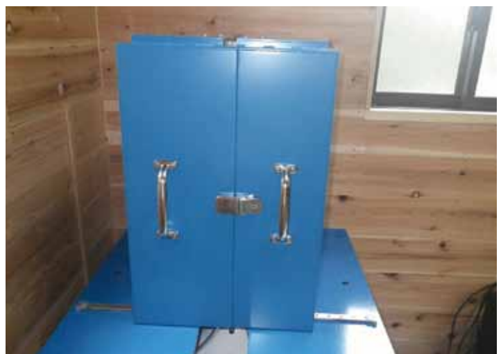
ミレーン2の新しい鉛遮蔽体
