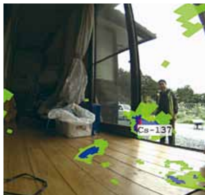
写真3 H氏宅廊下のガンマ線イメージング
