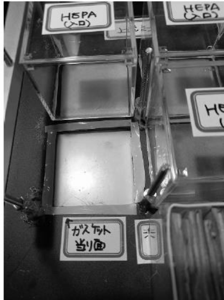
写真4；HEPAユニット1個を取り外したガスケットのあたり面（取り付け枠）を想定
