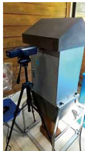
ハイボル外気取り込み口にパーティクルカウンタを設置した状態
