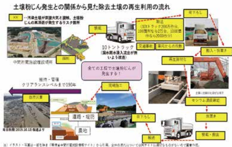
図 1. 汚染土再利用の全工程。環境省の中間貯蔵減容化に係る各 WG の資料から筆者が編集作成したもの
